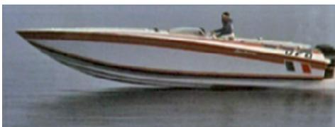
**Carena P.D.P. System. Dati imbarcazione: L.O.A. 31', Disl. 2,7 t., Motor. 2 x 200 HP f.b., Velocità 61 nodi (69 MPH)**
